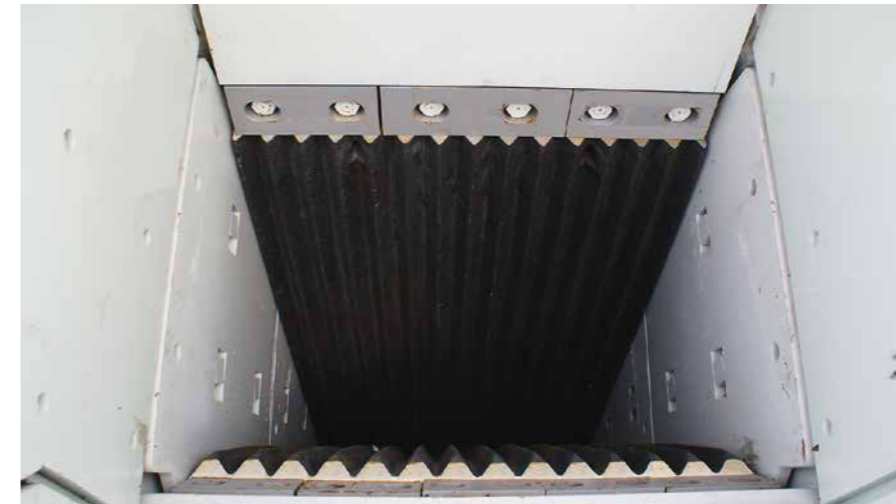
Optimierte Brechraumgeometrie mit langen Brechbacken
