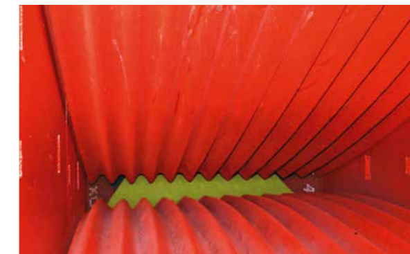
Abweisblech zur Schonung der Förderbandgurte
