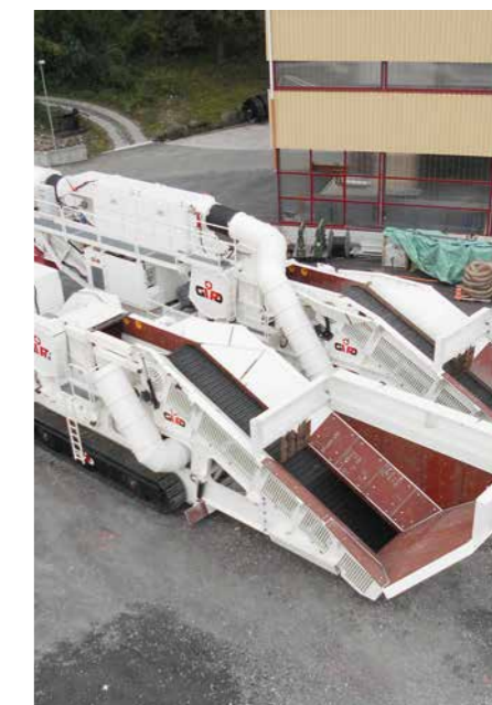
B 1185 FDR PB mit elektrischem Antrieb, Plattenband und Filteranlage für den Tunnelsatz
