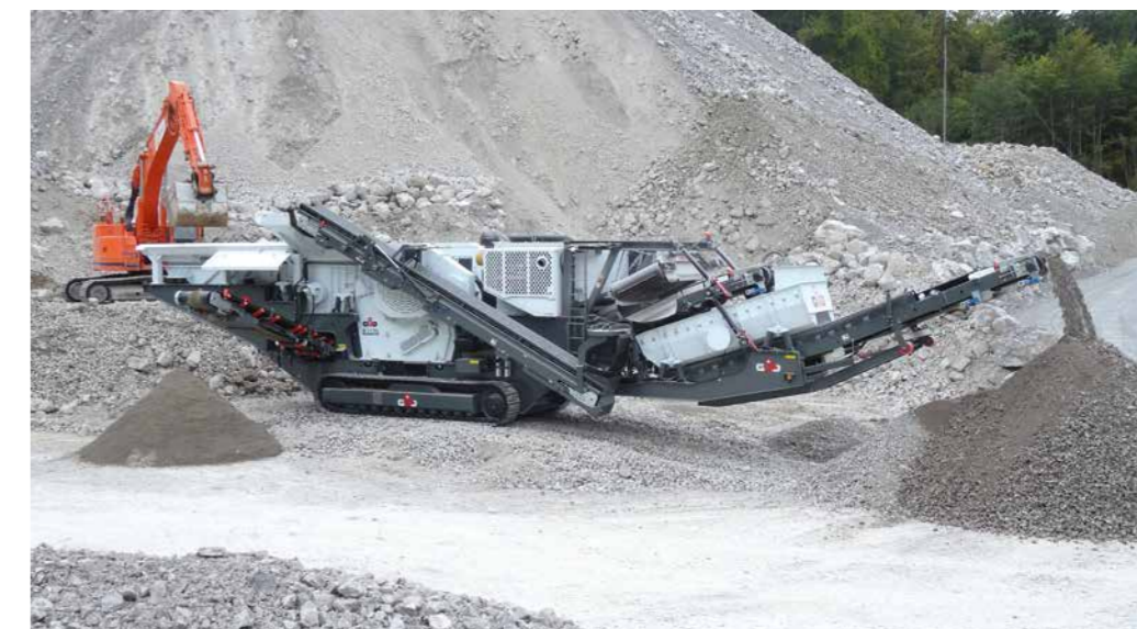
B 1170 FDR GIGA mit Vorabsiebung und Seitenausstrag
