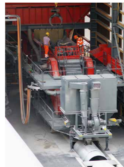
B 1410 raupenmobil mit Plattenbandaufgabe im Hartgestein (3'900 kg/cm 2 )
