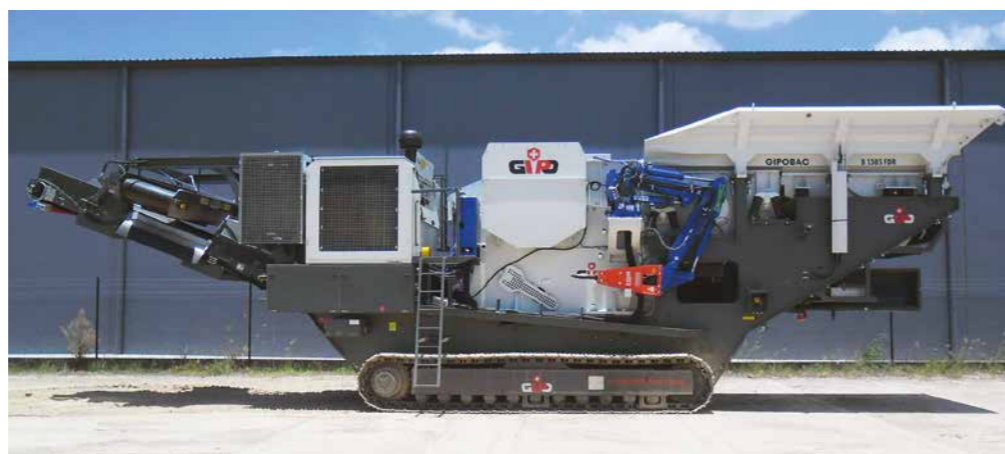
B 1385 FDR mit aufgebautem Spitzhammer
